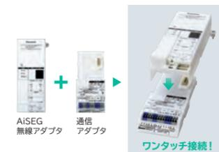
AiSEGとの通信に必要なAiSEG無線アダプタを標準搭載。また、ガス・水道・創畜連携システムなどと接続する通信アダプタ（オプション品）をご用意しています。
