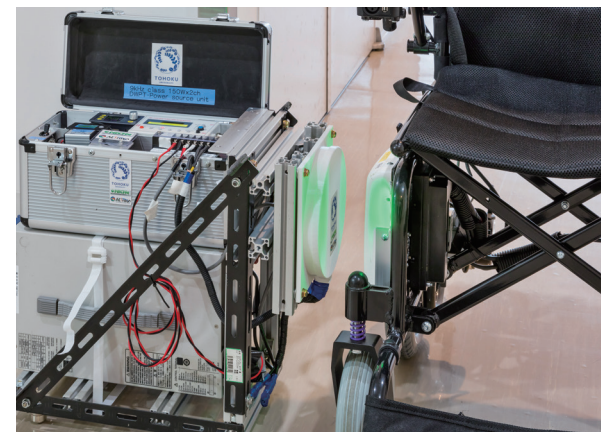
電動車椅子へのワイヤレス給電をデモ機で実験。約30cmの距離まで離れても充電が可能で、バッテリーを充電する作業がとて楽になる。
