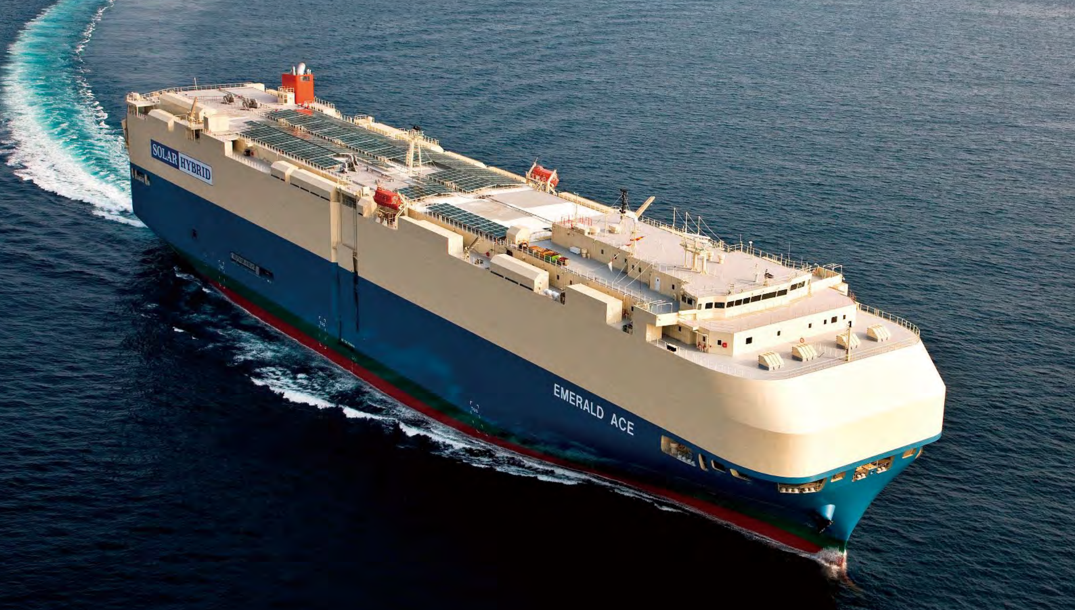
全長199m、全幅32.26m、高さ34.52mのハイブリッド自動車運搬船は6,400台の小型車が搭載可能
