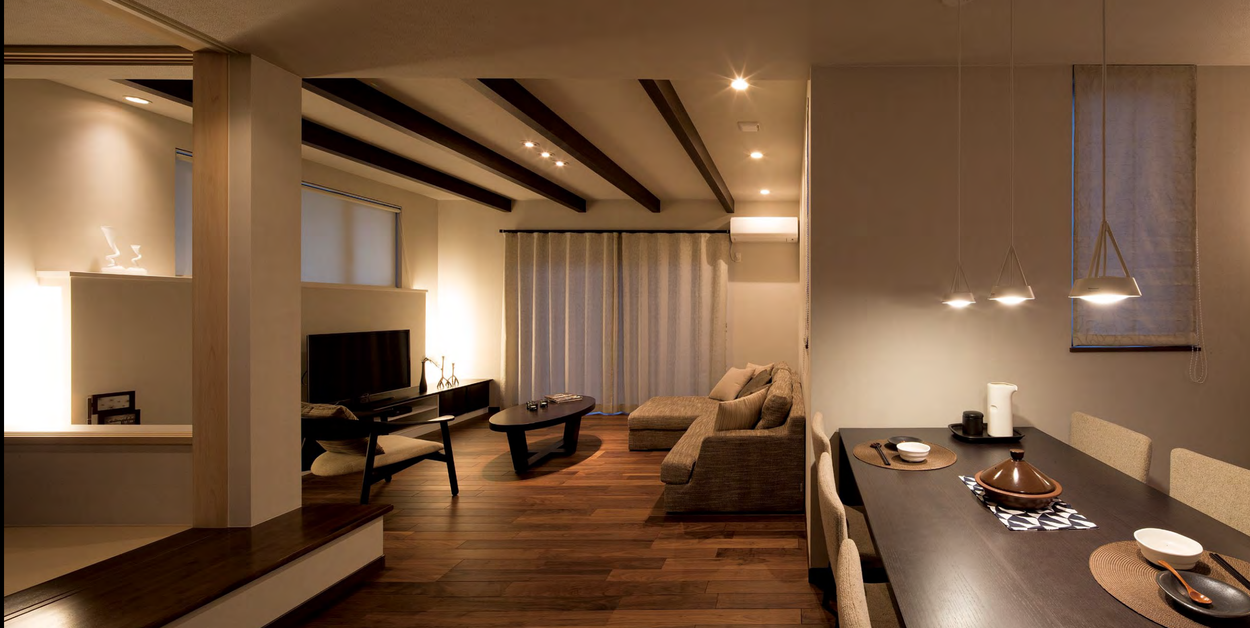
あらかし天井のリビングにはLEDダウンライトや建築化照明を配置。 リビングライコンによってLDKにあかりのシーンがつくりだされている
