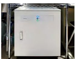
災害時には緊急電源として利用されるリチウムイオン蓄電池
