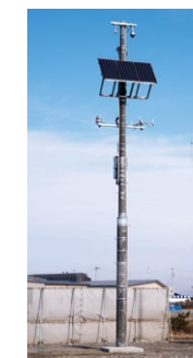
今回の津波より高い7mに設置された大曲海岸の津波監視システム
