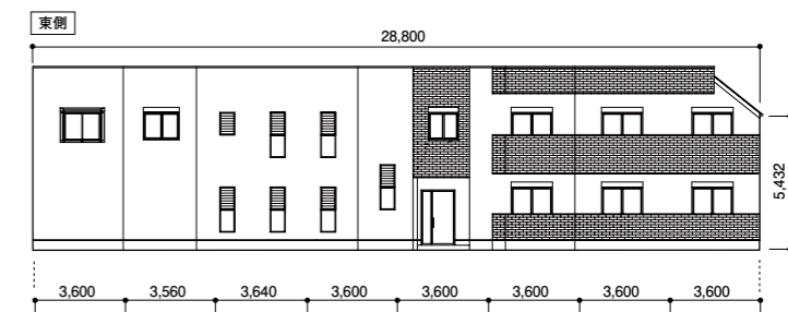
斜線制限に対応した居室の天井(右上)
