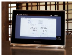
住宅機器コントローラーのモニターで、電力や空気質も「見える化」
