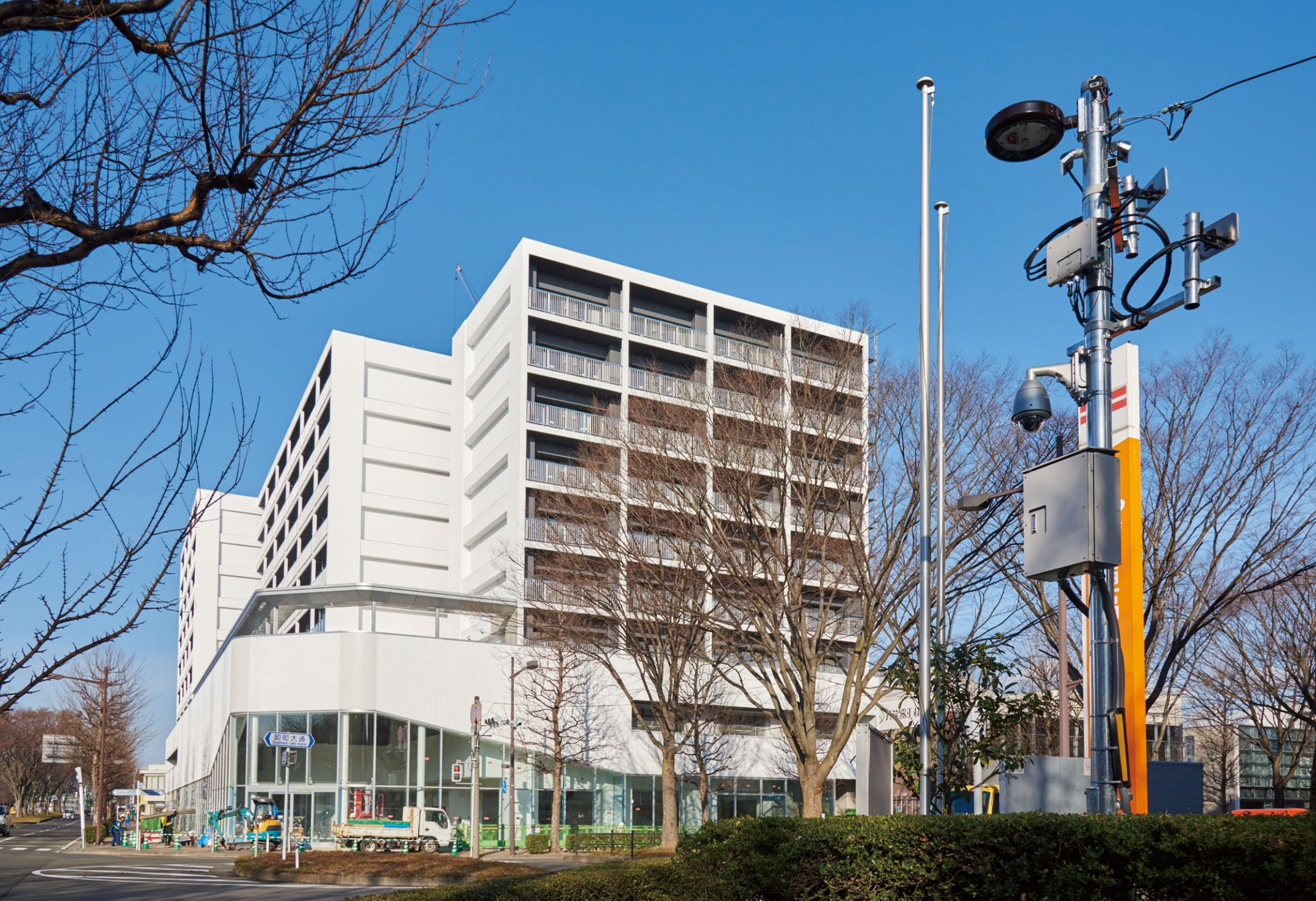
卸町会館前に設置された、防犯カメラを装備した防犯灯。背後は卸町コミュニティプラザ（復興公営住宅複合ビル）。災害発生時には防犯灯の光を赤色に変えて注意を促す
