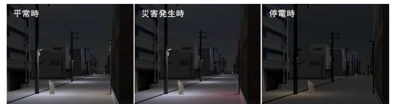
LED街路灯の配置や平常時・災害時発生時・停電時なども環境計画支援VRによりシミュレーション
