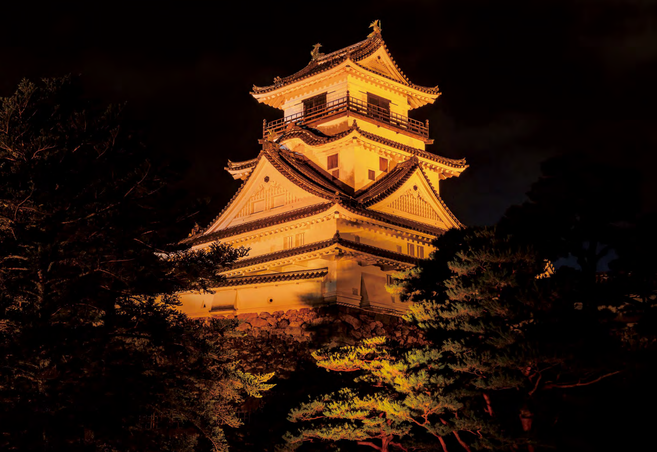
狭角・中角・広角の合計5台の投光器を組み合わせることで、均斉度の高いライトアップが実現されている
