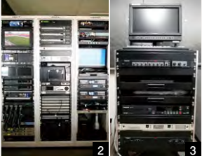
1.映像を見ながら直感的な操作が 可能なスイッチャー 2.映像制御・送出 装置 3.移動車のライブスイッチャー
