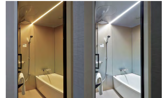
夜には暖色で照度を落として安眠を誘い、朝には白く明るい光で覚醒を促すi-X INTEGRAL BATHROOMの照明
