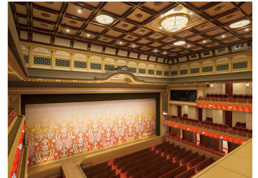
昭和初期から設置されていた大型シャンデリアやペンダントなどの装飾照明は光源のみをLED化して器具を保存再生
