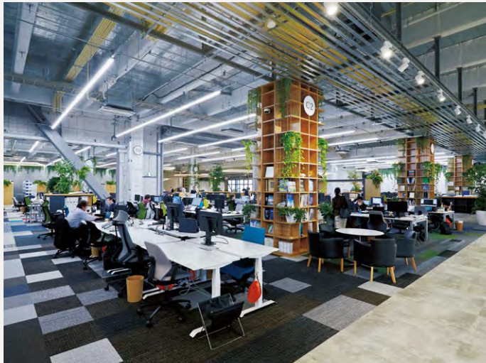
サーカディアン照明制御。写真左:5000K 900 lx(9~13時)から 写真右:3000K 400 lx(20時以降)へと移行する
