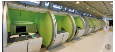
①ビデオテーク。ビデオ、カセットをロボット制御で再生装置にかけ、来館者が閲覧する装置。当時の最先端技術。現在は、可視光通信を使った最新式のシステムに更新されている。②建築前の構想画。 ©国立民族学博物館
