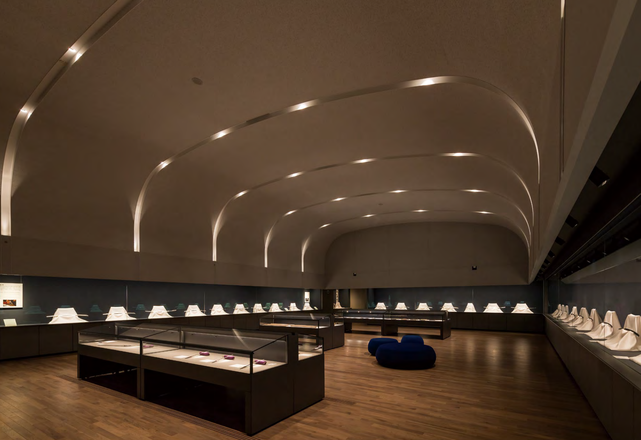
展示室では壁面展示ケースに日本刀が展示され、ベース照明には3000Kのダウンライト、刀剣には3000Kの特注フード付高演色調光スポットライトが用いられている
