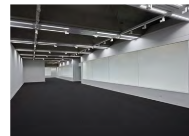
作業灯には建築構造と一体化する シームレス照明を採用
