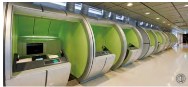
①ビデオテーク。ビデオ、カセットをロボット制御で再生装置にかけ、来館者が閲覧する装置。当時の最先端技術。現在は、可視光通信を使った最新式のシステムに更新されている。 ②建築前の構想画。
