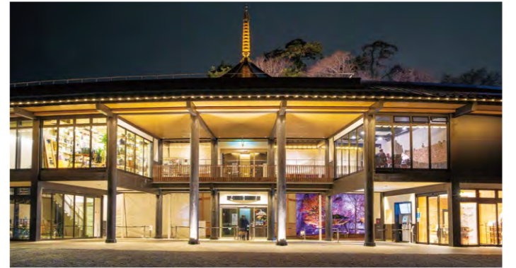
グレアレスダウンライトと小型投光器により柱を際立たせているファサード
