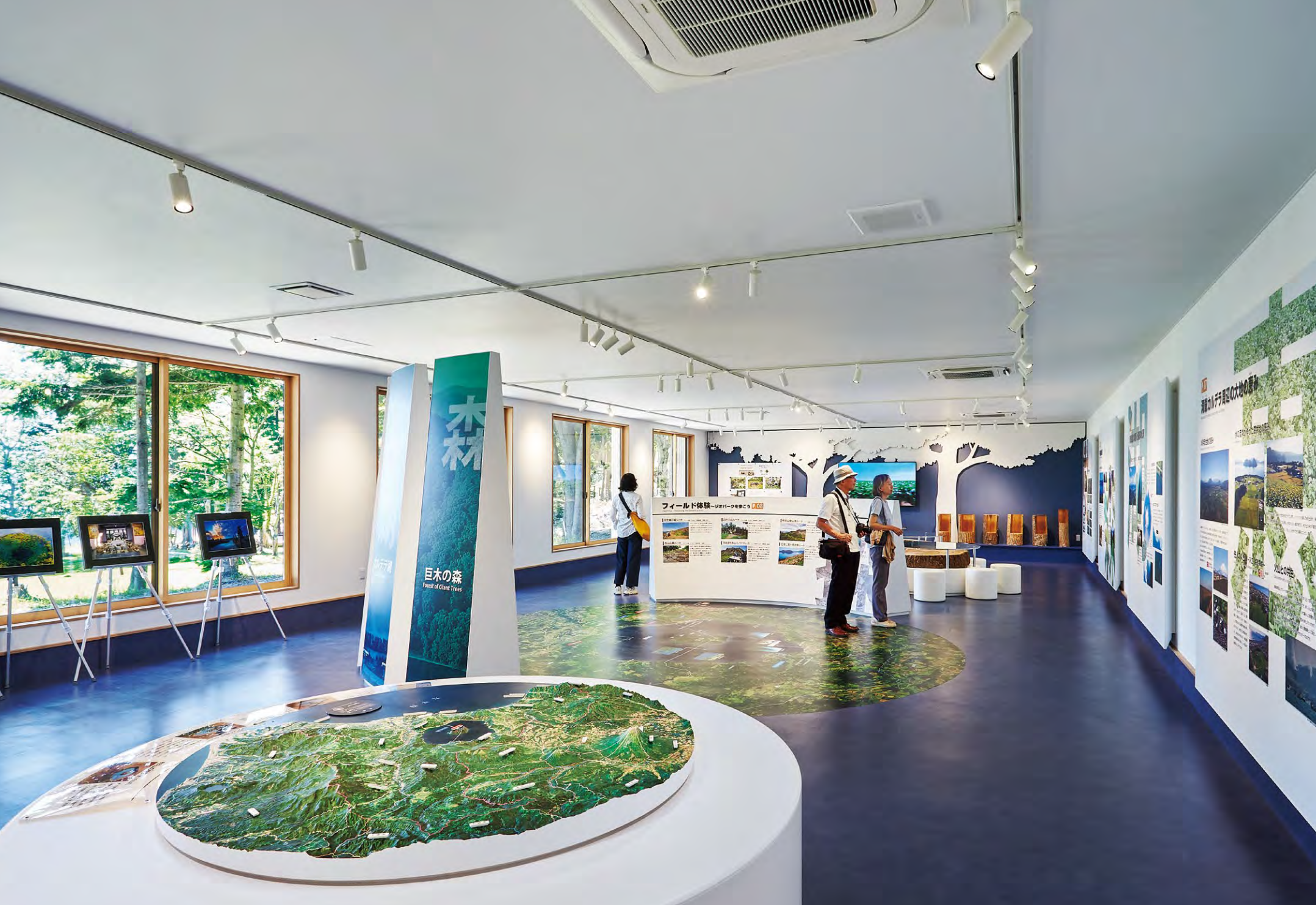
木と鉄の複合梁「テクノビーム」によって、木造建築でありながら情報全体が見渡せる柱のない空間が実現された約8m×18mの展示室
