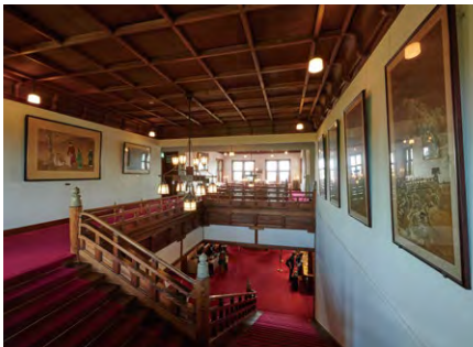
真壁造の1階に対し、2階は柱を見せない大壁造。回廊を巡って展示された数々の名画が鑑賞できる。
