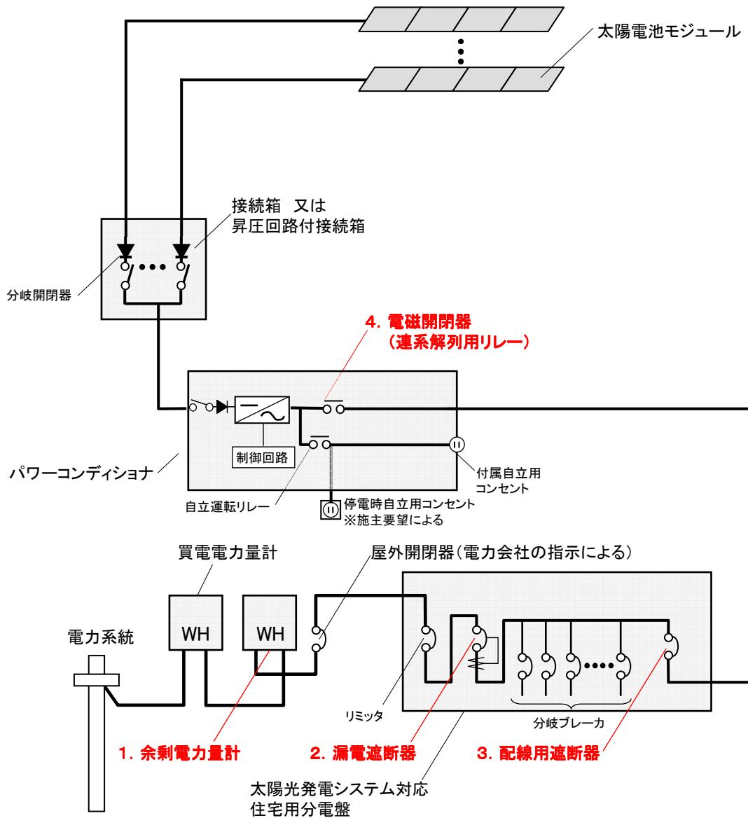
**受電設備構成(太陽光発電システム単線結線図)**
