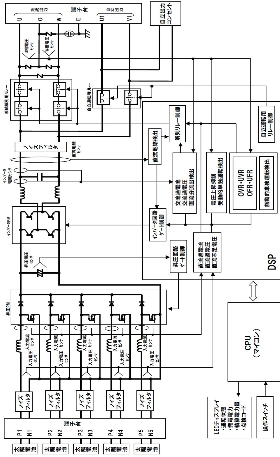
**受電設備構成(太陽光発電システム単線結線図)**
