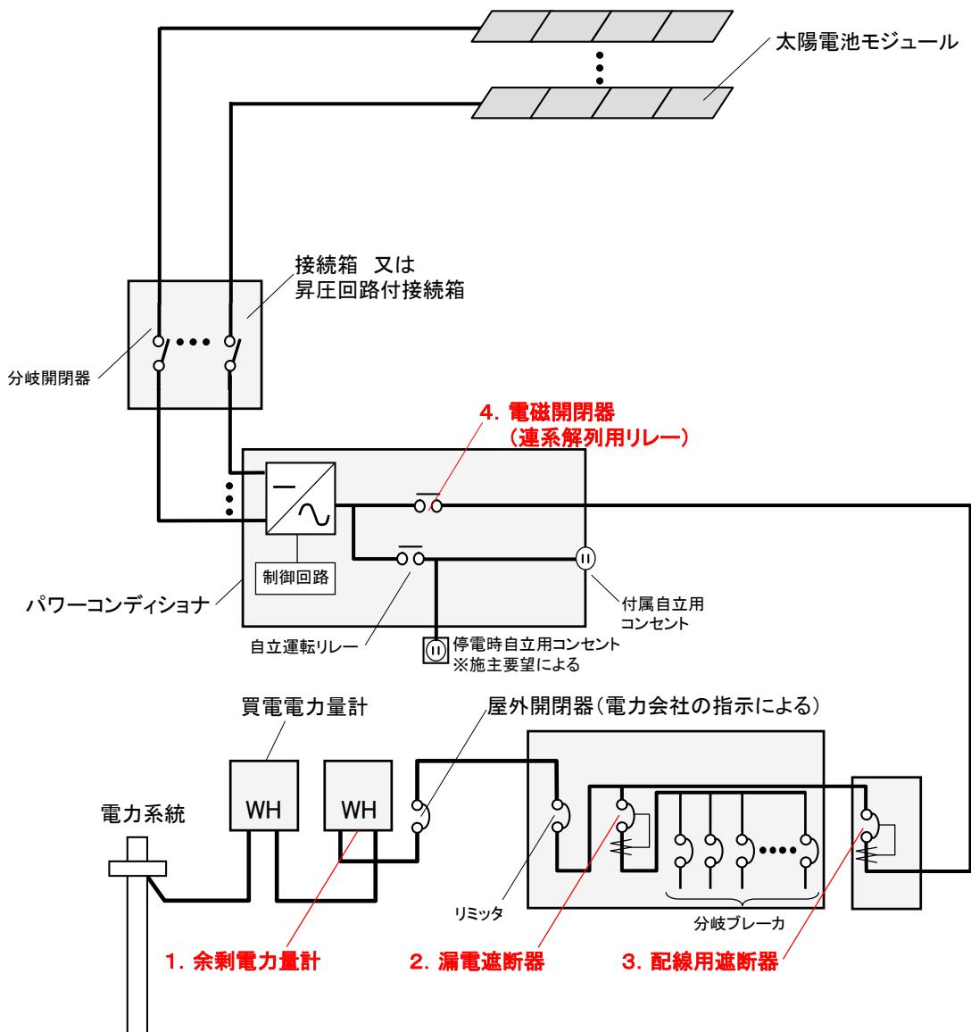
**受電設備構成(太陽光発電システム単線結線図)**
