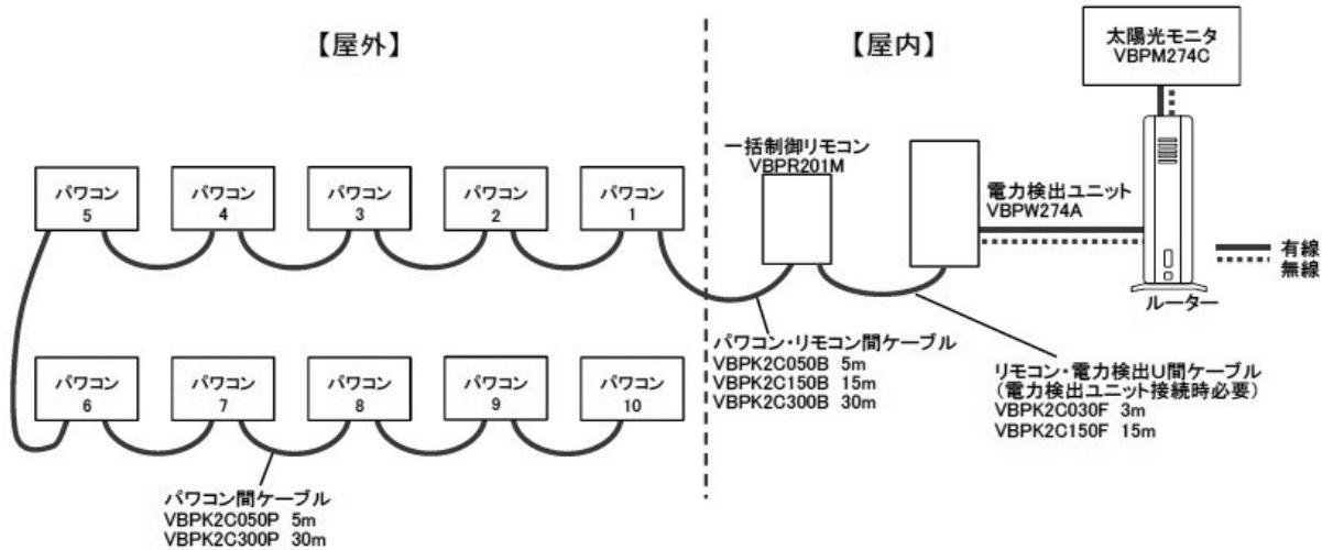
※マルチタイプ4.4kW/4.6kW/5.5kW/5.9kW、屋外集中5.5kWはパワコン及びリモコンのスイッチ設定により一括制御リモコンにて10台まで制御することができます。
