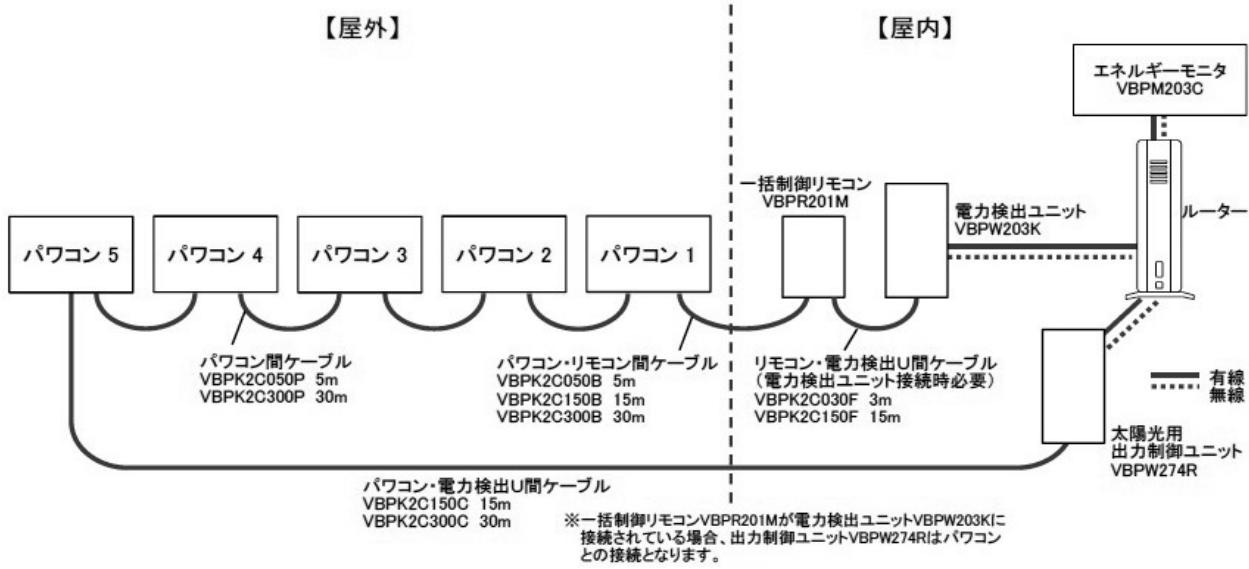
※VBPM203Kの場合、出力制御に対応させるには、出力制御ユニット(VBPW274R)を接続してください。
